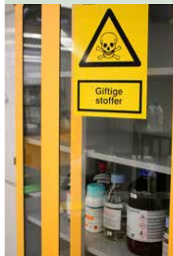
Skabe med giftmærkede stoffer skal være aflåselige og forsynes med advarselstavle
