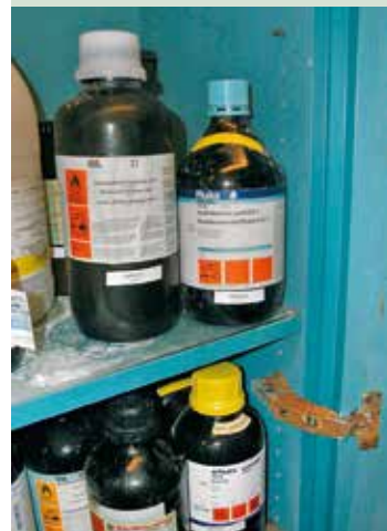
Stærkt ætsende kemikalier korroderer metallhængsler i opbevaringsskabe
