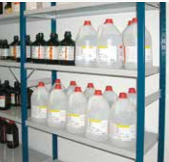
Ubrudte beholdere med brandfarlige væsker på åbne reoler. Når der er effektiv rumventilation, skal lageret ikke zoneklassificeres
