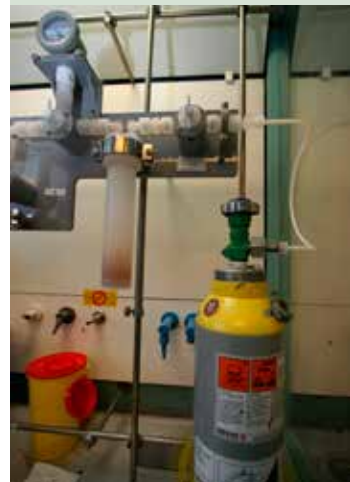
Mindre trykflasker med specialgasser anvendes ofte i laboratoriet. Her er en opstilling tilsluttet hydrogenfluorid placeret i stinkstøb
