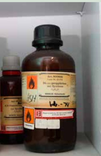
Diisopropylether kan danne det primære sprængstof triacetontri-peroxid (TATP). Den viste 40 år gamle flaske blev fjernet af et ammunitions-rydningsfirma
