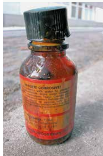
Eksempel på emballage med ødelagt skruelåg
