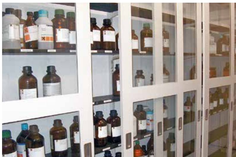
Reoler forsynet med skydelåger og ventilation
