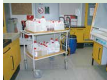
Rullebord med kanter og gummihjul er velegnet til transport af mange emballager
